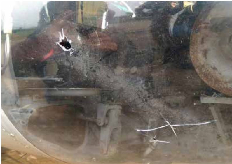
Figura 2. Disparo al parabrisas del helicóptero
